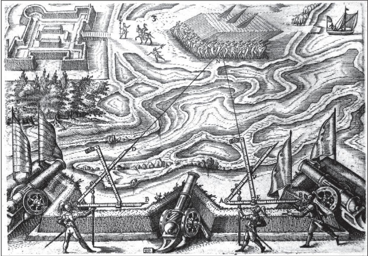
Abb. 3. Meßtechnische Situation im Lehrbuch: Schanzen, Artillerie und trigonometrische Geländeaufnahme (aus Bennett/Johnston, Geometry [wie Anm. 21], Nr. 51, nach B. Bramer, Bericht zu M. Jobsten Burgis seligen geometrischen Triangular Instruments, Cassel 1648).
